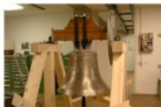
Glocke mit Klöppel, Glockenstuhl, Joch und Schwungrad
