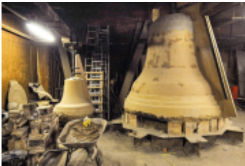
Herstellung des Glockenkerns aus Lehm mit drehbarer Schablone
